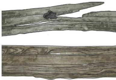
Figur 12: Kvisten i den övre limträbalken har gjort att balken brast tidigare än den undre vid brand (Svenskt Trä)
