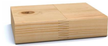
Figur 2: Fingerskarv i konstruktionsvirke (Svenskt Trä)
